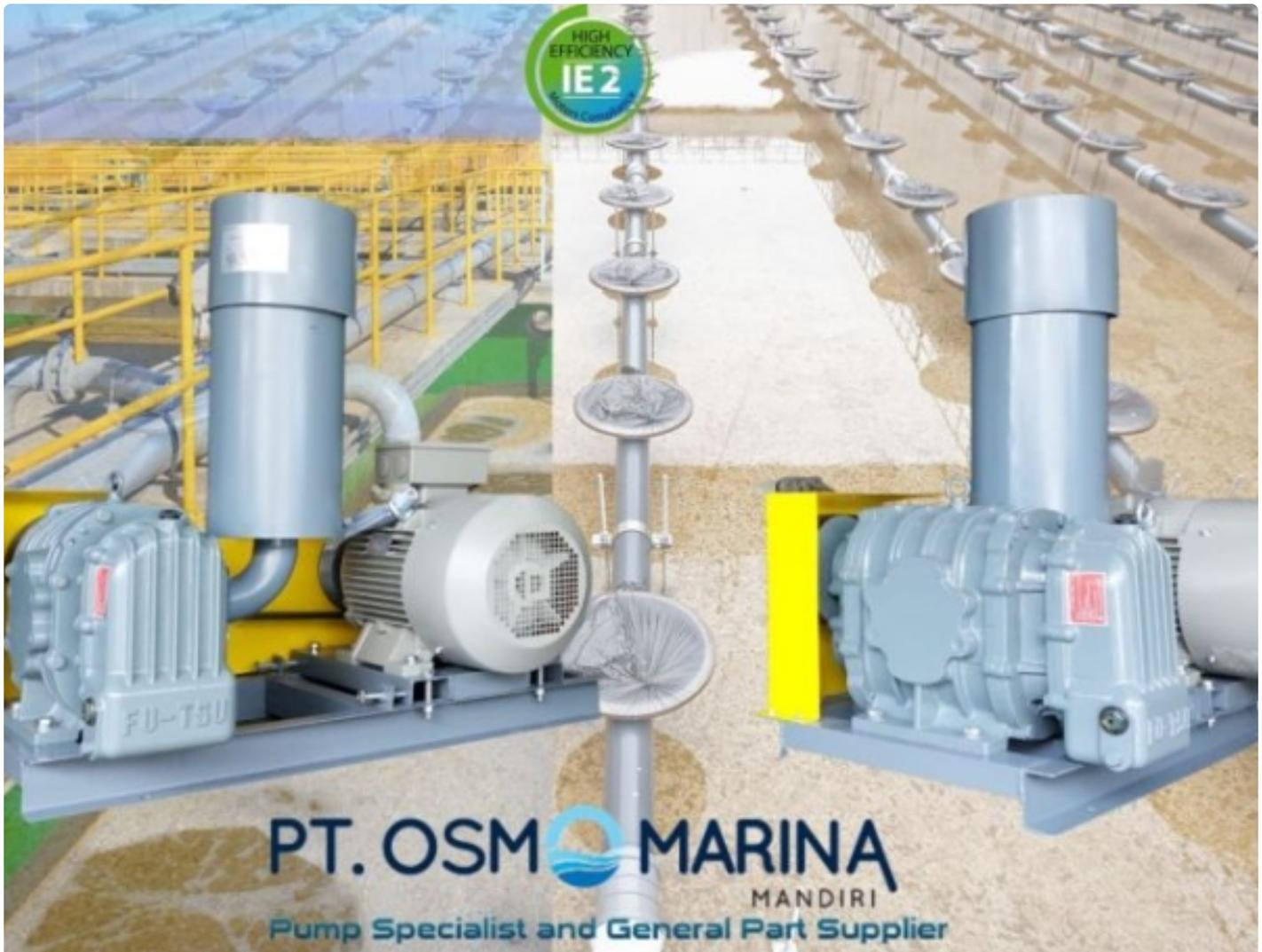
TEKNOLOGI - Mesin root blower yaitu mesin yang dapat menghasilkan aliran udara konstan yang tidak bergantung pada kondisi tekanan. Fungsinya mampu bekerja dan menggunakan pergerakan molekul dari zat yang berada di dalam suatu alat. Jadi prinsipnya adalah pemindahan atau perubahan lokasi yang akan terjadi dan untuk mendukung terjadinya pengompresan udara.
